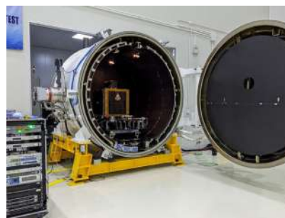
Thermal Vac Test
